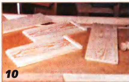
В передней и боковых стенках выбирают пазы для дна. Если используют салазки, пазы в боковых стенках не нужны. В боковых стенках делают выборки для задней стенки.
