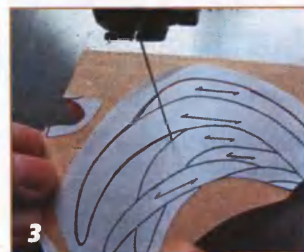
3 Выпиливая детали хвоста, сначала выпиливают одну сторону, затем выводят пилку из запила и выпиливают вторую сторону элемента.
