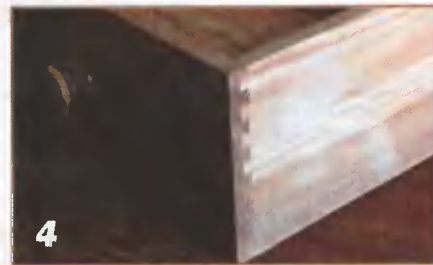
4 Современный выдвижной ящик из древесины сосны. Выбранные на станке пазы и шипы соединения «ласточкин хвост» хорошо скрепляют переднюю стенку с боковыми стенками.
