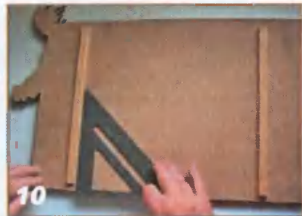
К задней стороне доски крепят планки для навески и красят всю доску.
