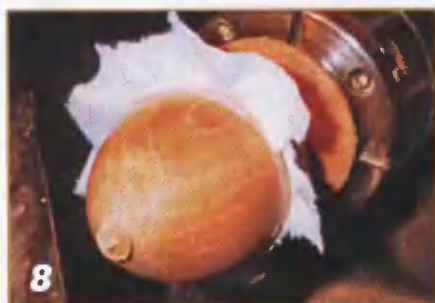
«Жёлудь» перевернут для обточки кромки.
