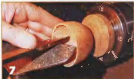
Отделка скобелем полости «жёлудя». И тут он тоже поддерживается пальцами
