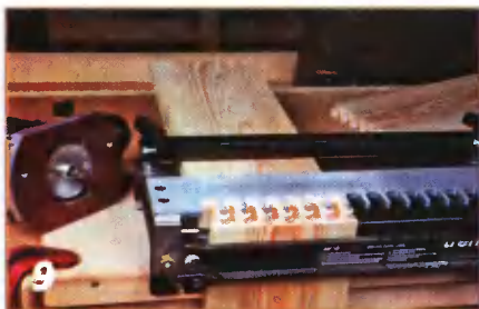
9 Соединение «ласточкин хвост» между передней и боковой стенками выбирают с помощью специального приспособления.
