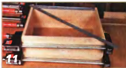
Все стенки склеивают и проверяют их прямоугольность.
