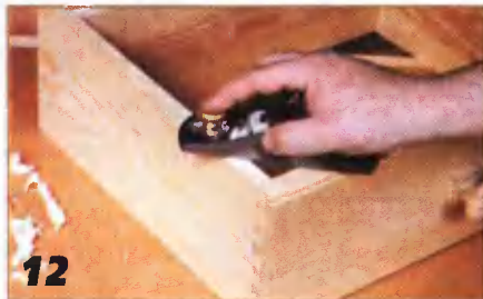
Коробку ящика подгоняют к проёму подстрожкой кромок стенок.
