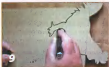
Собранную фигурку петушка кладут на обратную сторону доски и обводят.
