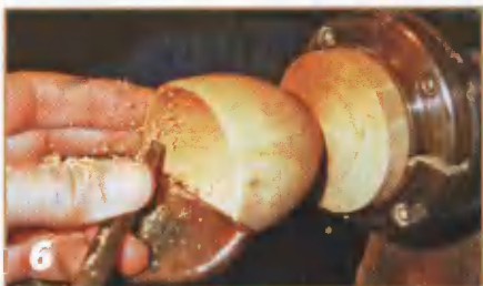
Выборка полости в «жёлуде». «Жёлудь» с внешней стороны поддерживают пальцами.
