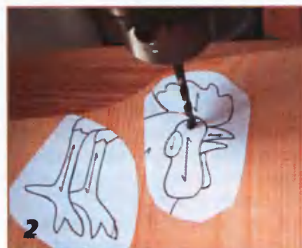
2 Глаз петушка проще просверлить до выпиливания деталей.
