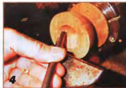
Начало выборки полости чашечки.
